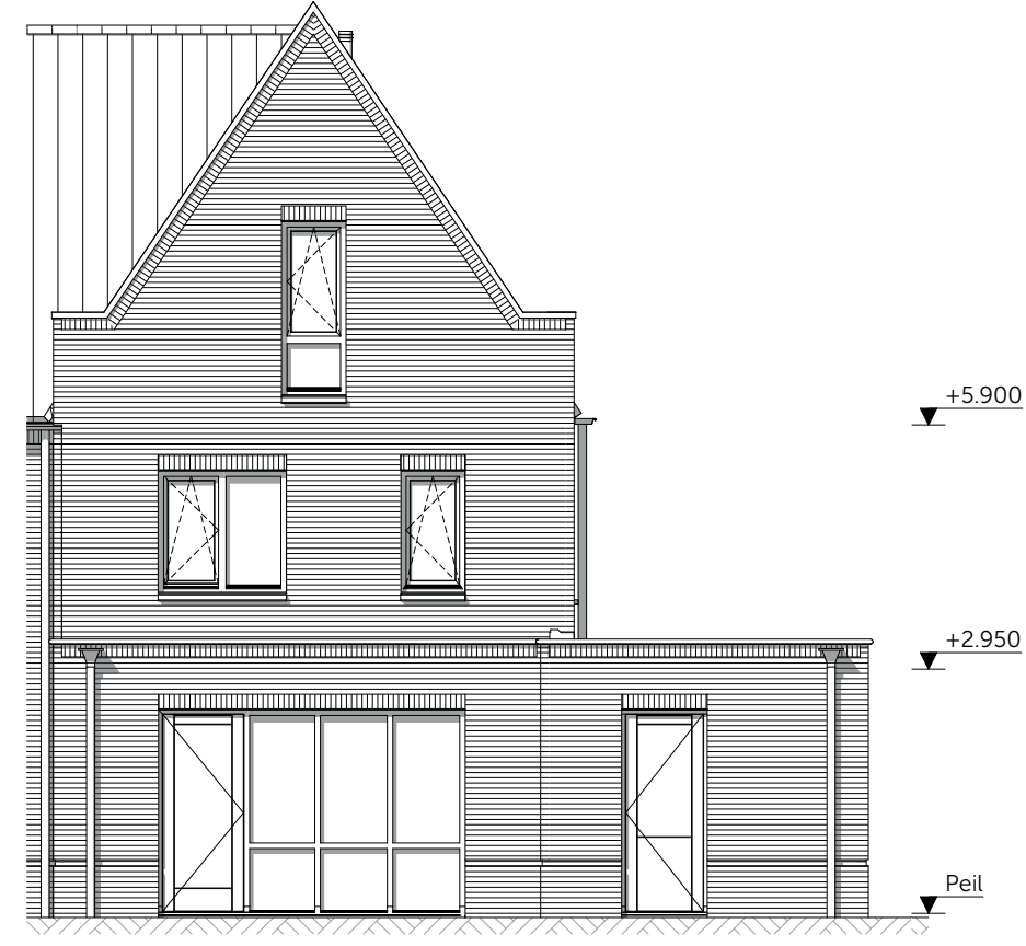
Achtergevel schaal 1:100 - Uitbouw 1,2m aan de achtergevel
