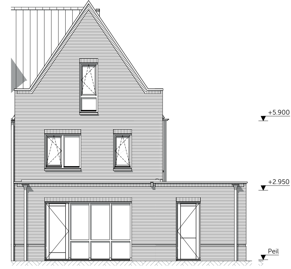
Achtergevel schaal 1:100 - Uitbouw 2,4m aan de achtergevel
