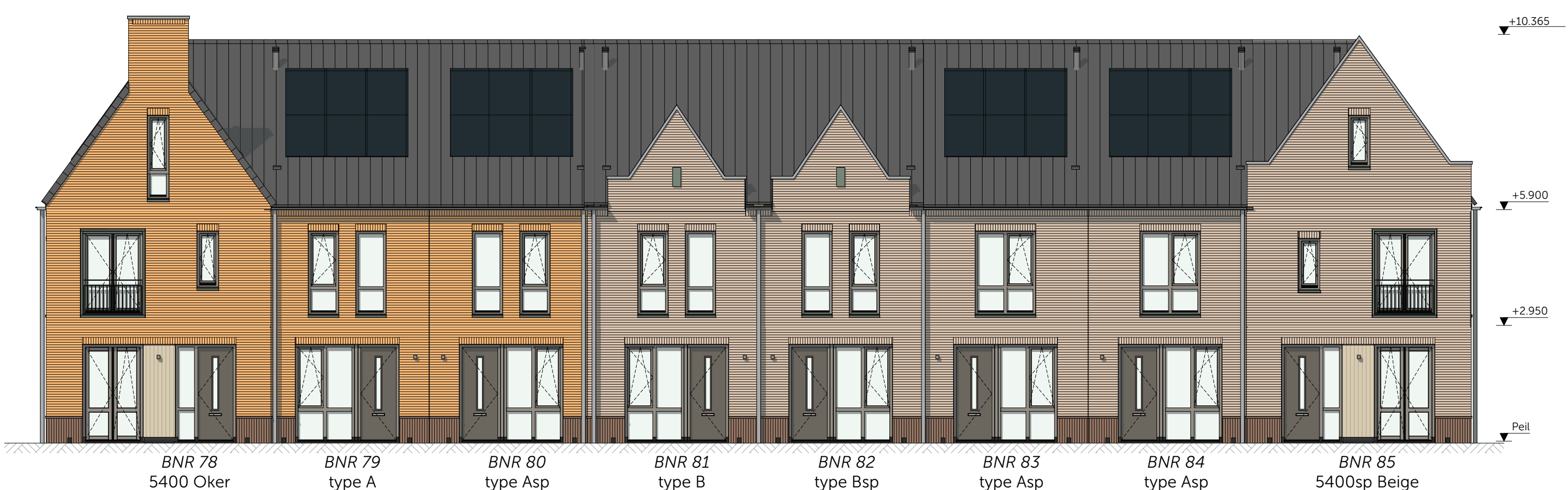
Voorgevel - Blok 31 - Oker/Beige schaal 1:100
